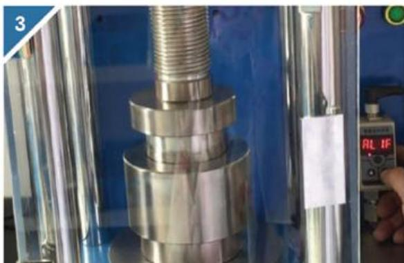
按▼键，选择RL1F后，按mode键，设置压片机压力到多大值系统自动停止加压的数值。然后返回按END键保存并退出。
