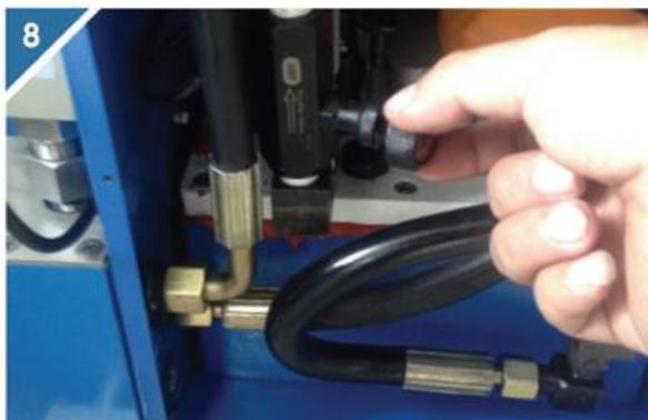
如果系统压力过冲过大，可以通过调节机箱内的溢流阀来调整过冲，顺时针增加过冲值，逆时针调整减少过冲值。
