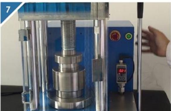
如果需要精确控制压力，可以通过右侧手动加压装置，将压片精确控制到所需压力。
