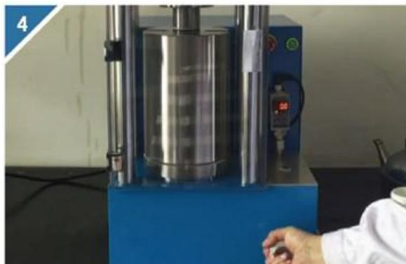
4 将丝杠顶住等静压腔体，关上防护门，并紧上放油阀杆。
