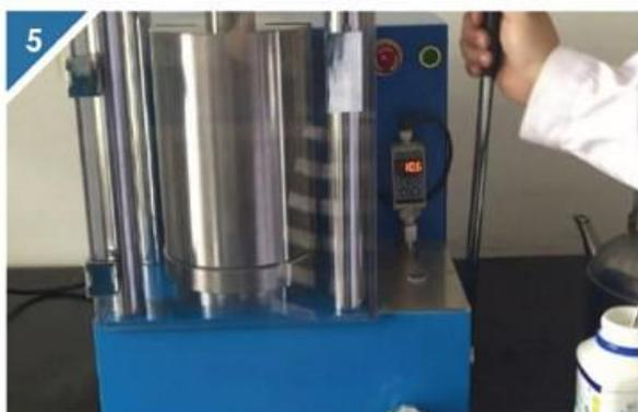
5 将压片机压到所需压力。
