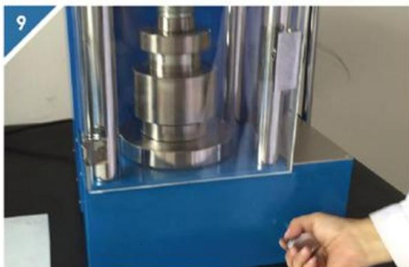
9 按下绿色启动按钮，将压片机的电源关闭
