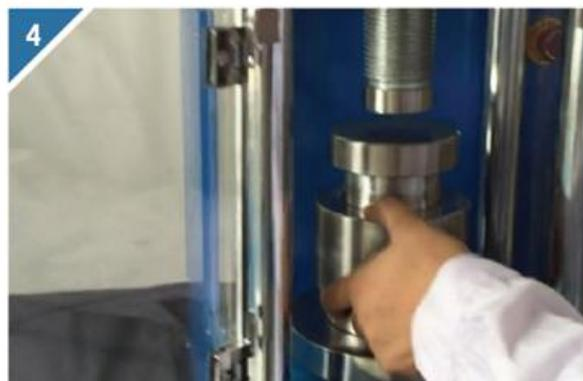
前三步设定压力值，只是第一次需要设定，设好压力值，我们将模具放到压片机的空间里，紧上丝杠压紧模具。
