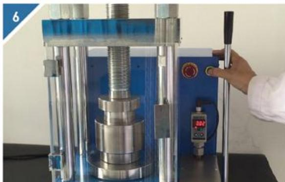
按下绿色的启动按钮，压片机开始加压，加到所设定的压力后，系统自动停机。
