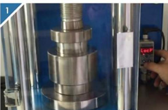
1 按下mode键，屏幕上显示LocP后，再按▲键，设置0001后再按一下mode键，进入控制菜单。
