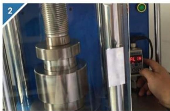
2 按下▼键，屏幕上显示RL1H后，按mode进入设置菜单，输入压片机低于多大压力自动补压的数值。
