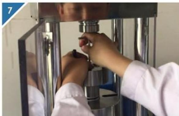
7 打开防护门，将等静压压头上的放气螺钉松开。
