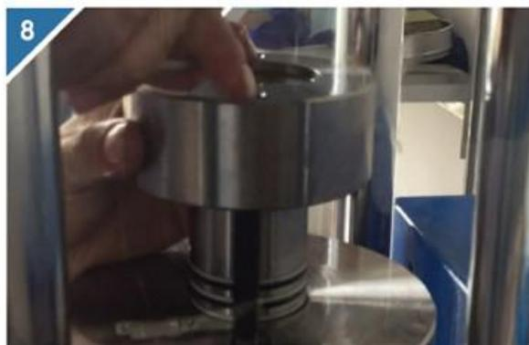
8 旋转压头上的螺钉，将等静压腔体上的压头取下。
